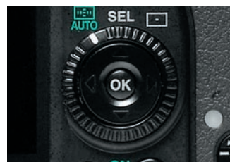
Джойпад Он отвечает за чувствительность, баланс белого и работу вспышки. Без нажатия на кнопку Fn джойпад остается неактивным.
