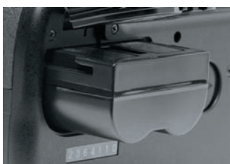
Питание Камера использует Li-ion аккумулятор, его хватает более чем на 500 кадров без вспышки.
