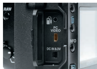
Разъемы На корпусе камеры есть разъем для ДУ, порт USB и видеовыход.
