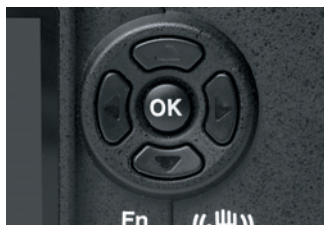
Джойпад При помощи джойпада осуществляется навигация по меню, а также управление режимами съемки, вспышкой, установками баланса белого и чувствительности.
