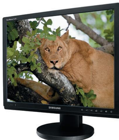
монитора, оснащенного светодиодной подсветкой. SyncMaster XL20 полностью отображает цветовое пространство Adobe RGB, позволяя без искажений воспроизводить естественные цвета, зафиксированные профессиональными цифровыми камерами. Благодаря светодиодной подсветке решается еще одна проблема LCD-мониторов — неравномерность подсветки. Диагональ — 20,1", разрешение — 1600 x 1200, контрастность — 1000 : 1, время отклика — 8 мс (GTG).
