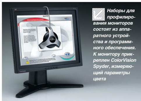
*Наборы для профилирования мониторов состоят из аппаратного устройства и программного обеспечения. К монитору прикреплена ColorVision Spyder, измеряющий параметры цвета*
