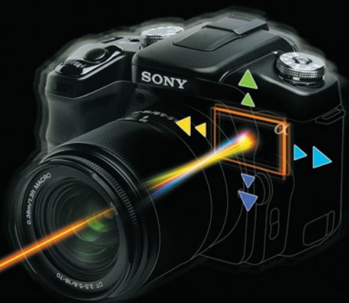
Система стабилизации изображения Super SteadyShot встроена внутрь корпуса фотокамеры и основана на сдвиге светочувствительной матрицы.
