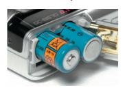
Камера работает от двух аккумуляторов АА. Полностью заряженных элементов питания хватает примерно на 150 кадров.
