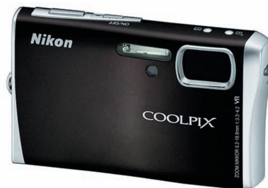
не оптическая схема, а прибор) для уменьшения толщины корпуса, стабилизатор изображения и мощная 9-Мп матрица (правда, очень маленького физического размера). В распоряжении фотографа автоматическая фокусировка по лицам, простейшее внутрикамерное редактирование, фирменная никонская технология D-Lightning и, конечно, сам WiFi-модуль. Для тех же, кому беспроводная связь ни к чему, выпускается версия без WiFi-модуля — CoolPix S52. Она чуть уже и немного дешевле.
